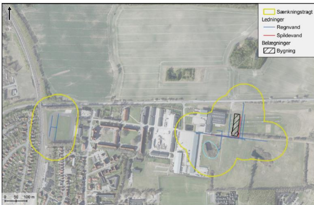
Figur 2 Beregnede sænkningstragter, der er beregnet ud fra en meget konservativ hydraulisk ledningsevne for hver af de to lokationer.
